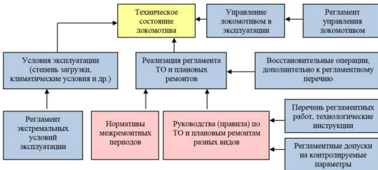
Рисунок 1 – Структура основных факторов, определяющих техническое состояние локомотива
