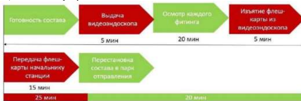
Рисунок 3 – Схема осмотра фитинговых упоров вагонов-платформ по новой технологии (в груженом состоянии)
