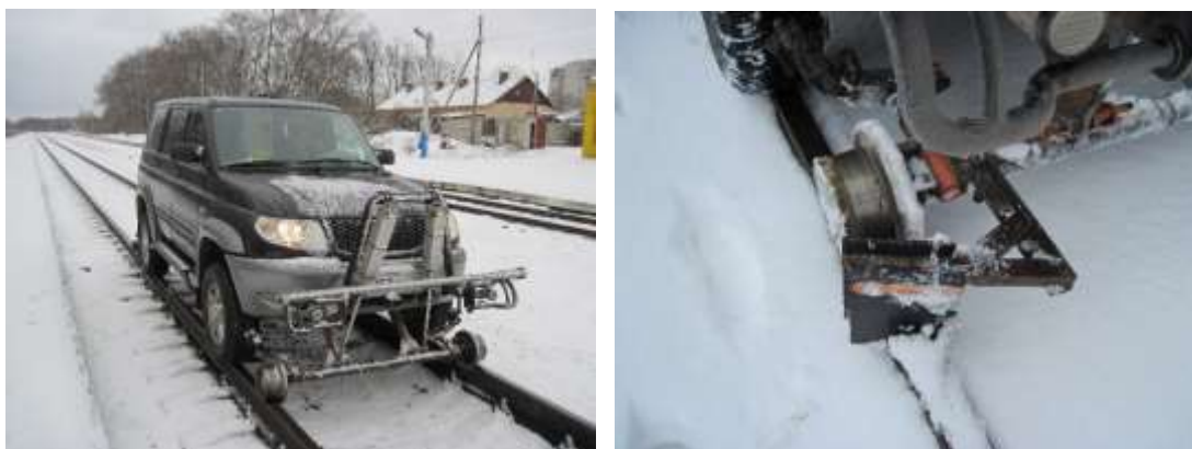
Рисунок 1 – Работа устройства для очистки рельсовых путей на машине ЛДМ-1
