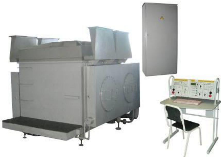
Рисунок 1. Установка ультразвуковая мойки и пропитки остовов ТЭД
