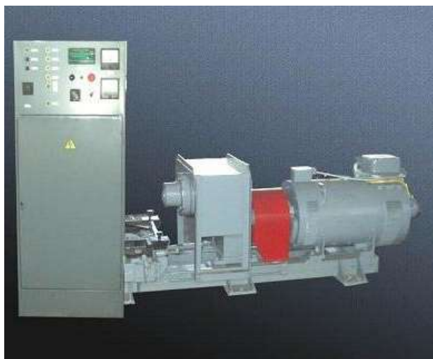
Рисунок 1. Внешний вид стенда для обкатки КТ-6
