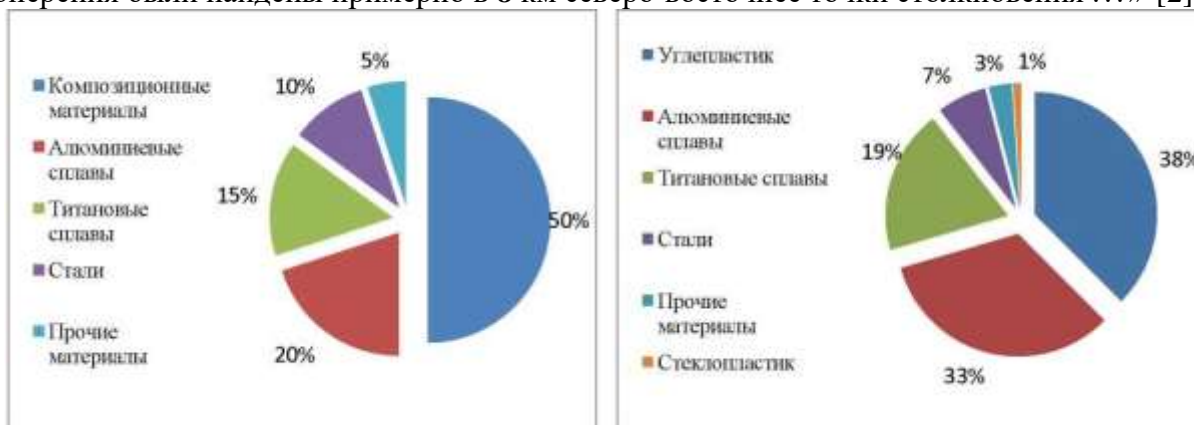
Рисунок 2 - Материальный состав воздушных судов типа Боинг 787 Dreamliner (слева), SSJ 1XXи IRCUTMS 21 (справа)
