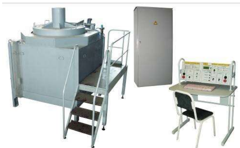
Рисунок 1 Установка мойки и пропитки тяговых электродвигателей
