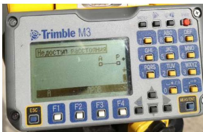
Рисунок 4 – Алгоритм определения ширины колеи подкранового пути: а – недоступные расстояния; б – недоступные расстояния (результат)
