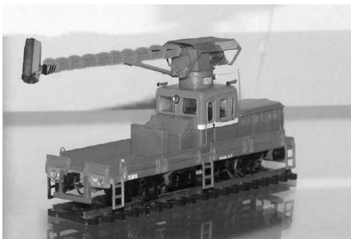
Рисунок 1. Дрезина ДГКУ с модернизированной манипуляторной установкой и роторным мульчером
