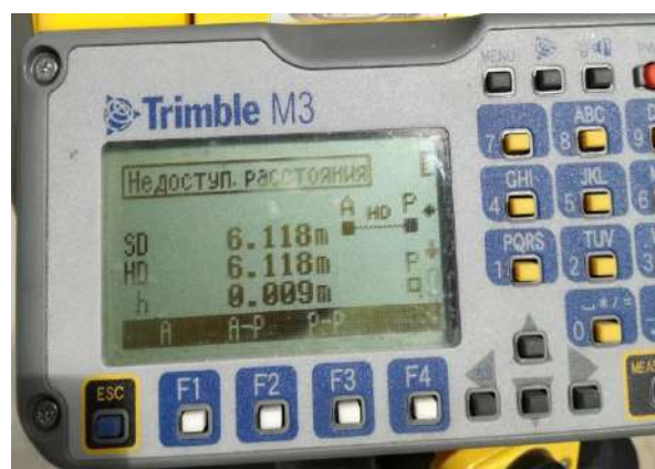
Рисунок 4 – Алгоритм определения ширины колеи подкранового пути: а – недоступные расстояния; б – недоступные расстояния (результат)
